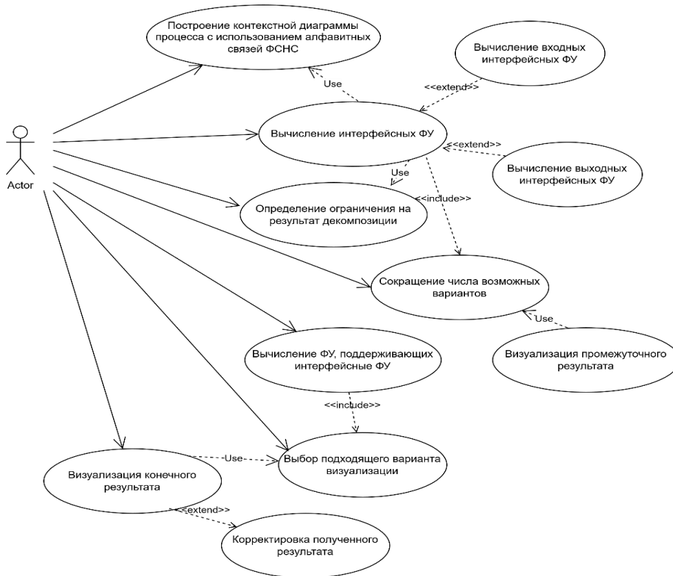
Рис. 1. UML-диаграмма вариантов использования инструментария автоматизирующего построения графических моделей с использованием ФНС Fig. 1. Use case diagram of tools for automated construction of graphical models using the FSNS
