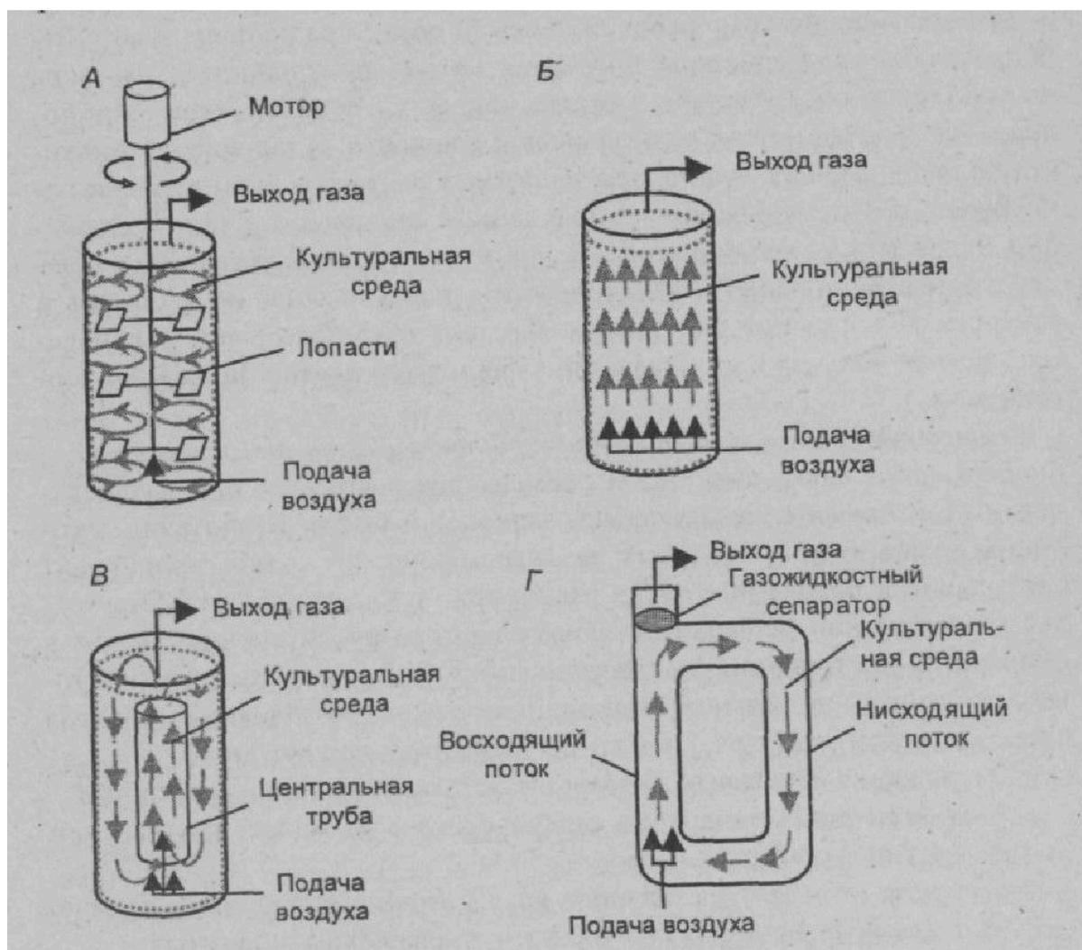
Рис. Схемы биореакторов различных типов с указанным стрелками направлением потока культуральной среды: А - реакторы с механическим перемешиванием, Б - барботажная колонна, В - эрлифный реактор с внутренней циркуляцией, Г - эрлифный реактор с внешней циркуляцией.
